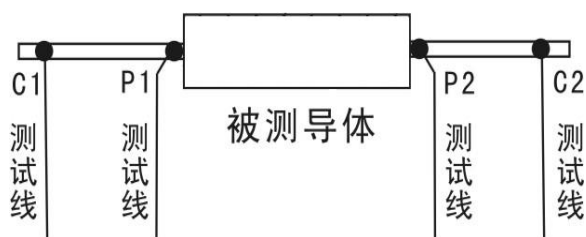
图1 等电位电阻测试仪工作原理图
