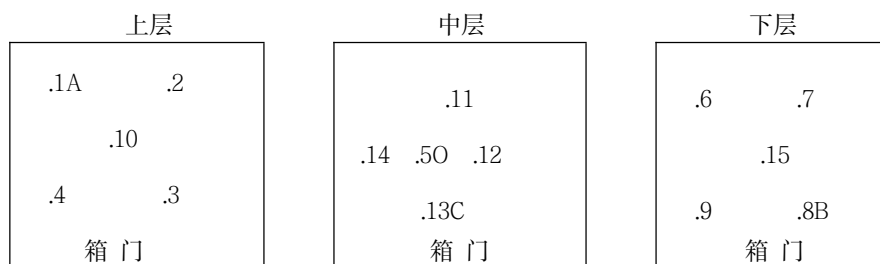
图 2 砂尘试验设备容积大于 2\text{m}^3 时温度、湿度测量点布放位置示意图
