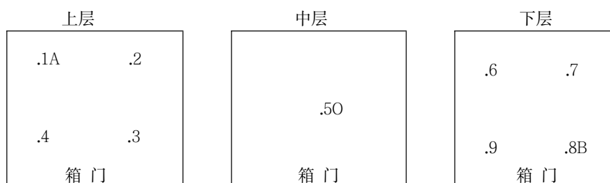
图 1 砂尘试验设备容积小于或等于 2m 3 时温度、湿度测量点布放位置示意图
